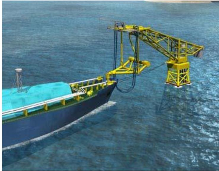
Figura 11 Un punto de descarga de GNL
