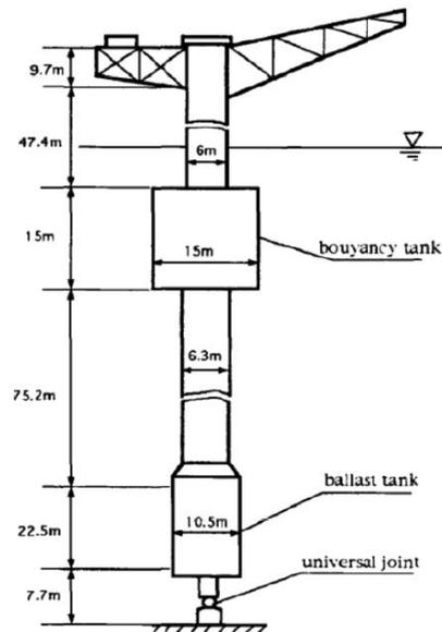
Figura 6. A. Diagrama de una plataforma articulada.
