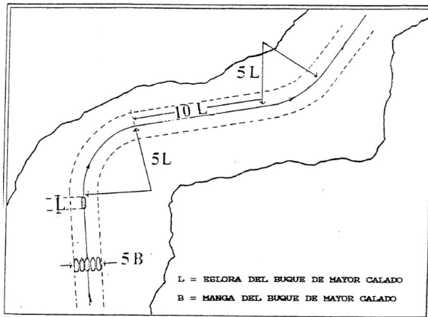
Figura 3. Trazado de Curvas y Rectas del Canal
