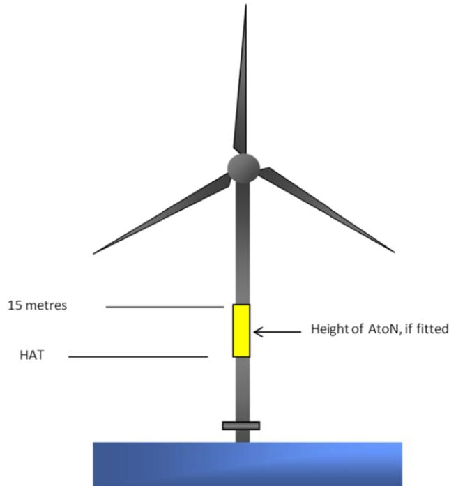
Figura 1 Señalización de muestra de un aerogenerador individual.
