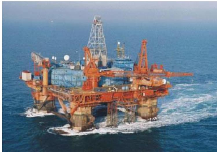
Figura 10 Un ejemplo de un Flotel.
