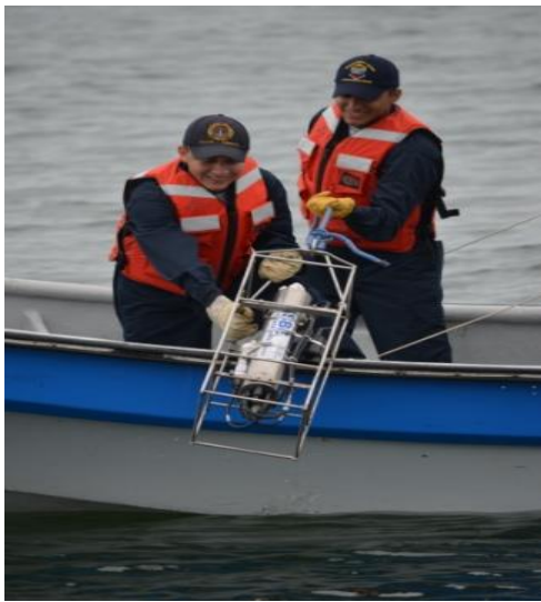
Ilustración 12 - Sistema de Medición de Parámetros Oceanográficos y de Meteorología Marina (SMPOMM) en Buenaventura
