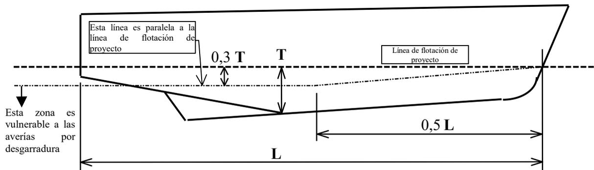
donde:  $T$  = calado máximo del casco (en el caso de los buques multicasco cada uno de ellos considerado individualmente) en la línea de flotación de proyecto, excluida toda estructura no flotante.
