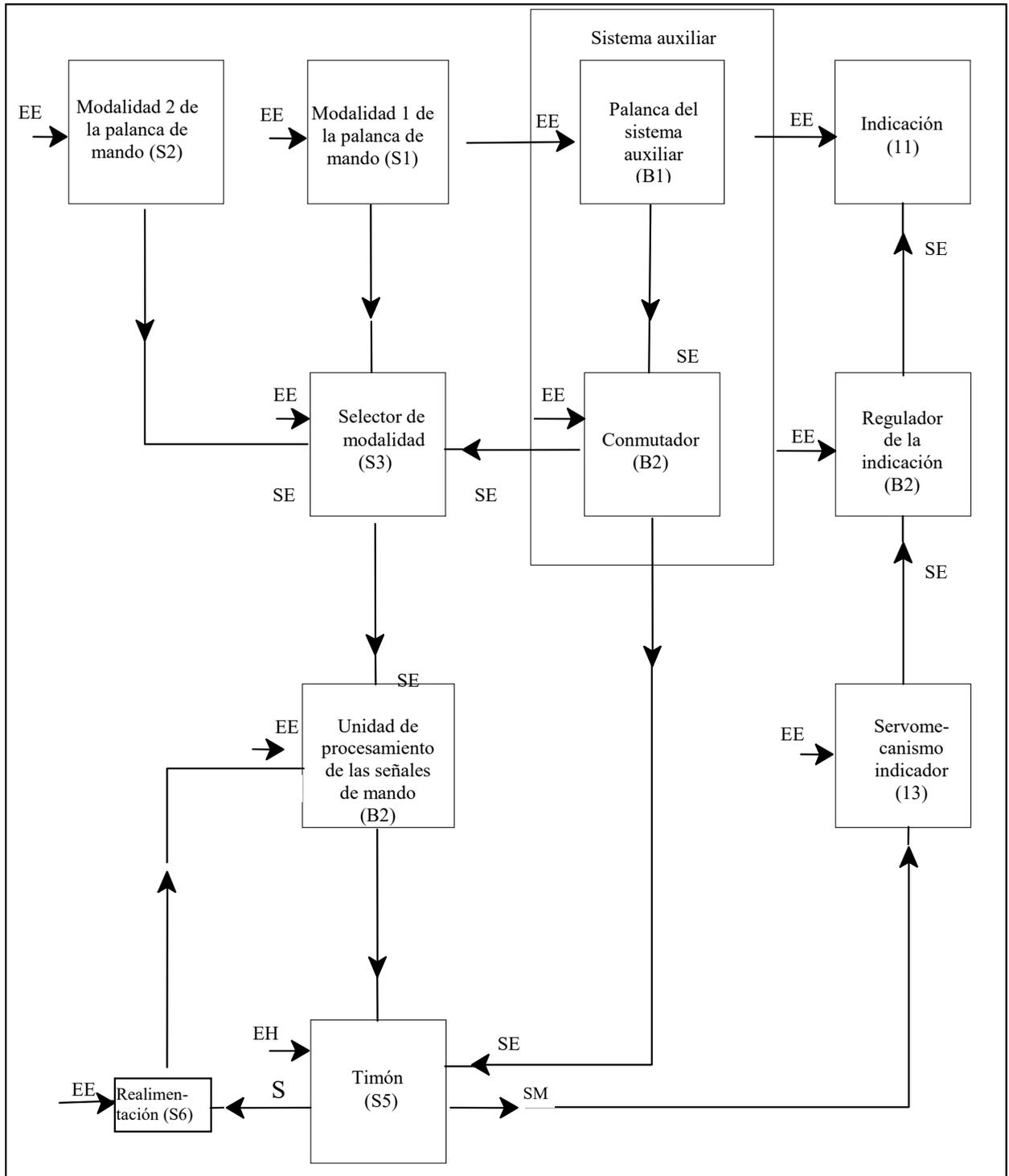
donde: EE: energía eléctrica; EH: energía hidráulica; SE: señal eléctrica; SM: señal mecánica
