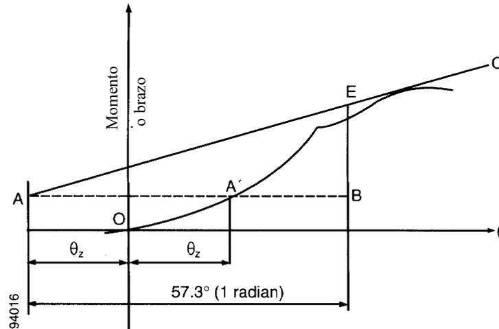
**Figura 2 - Curva de estabilidad dinámica**
