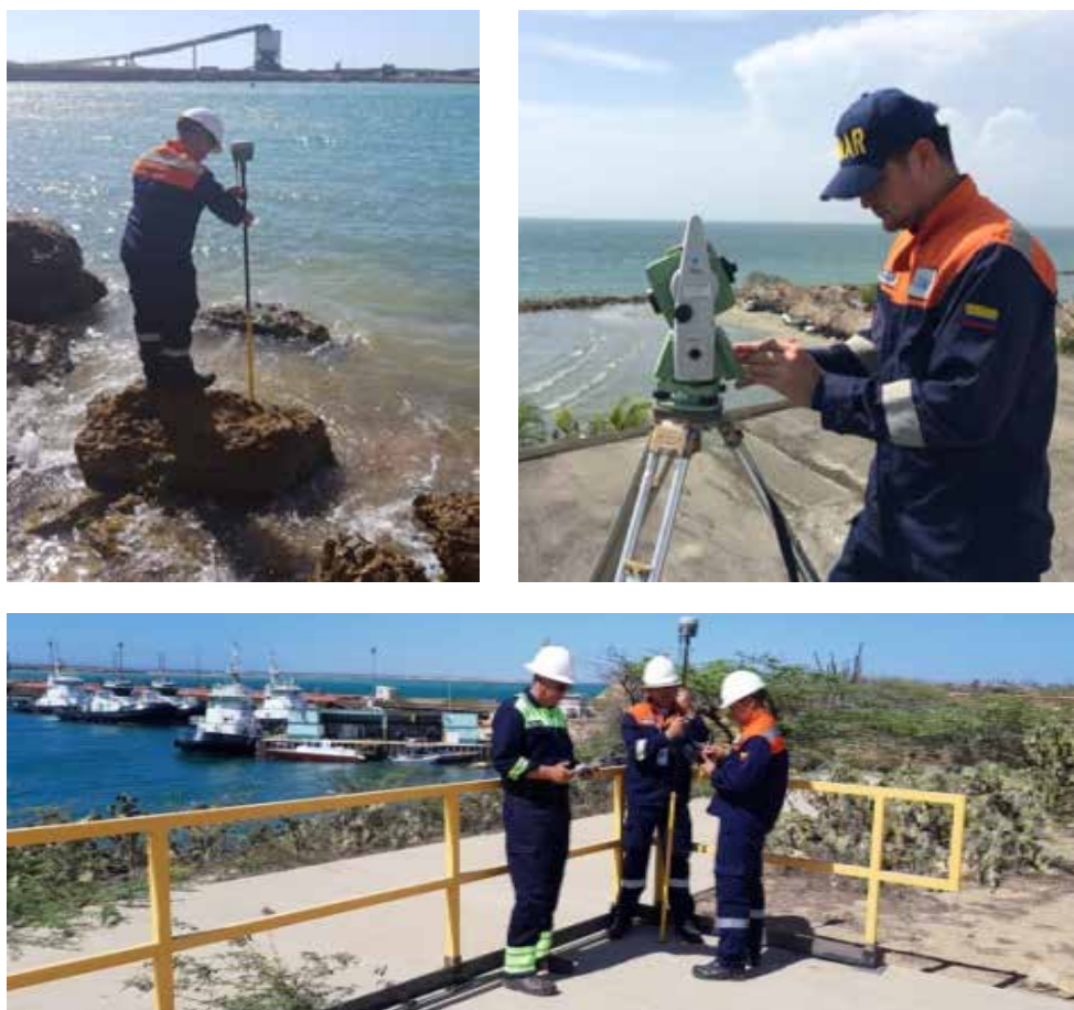
Figura 11. Levantamiento de información relacionada con la red nacional hidrográfica de referencia vertical para los puertos marítimos colombianos.
